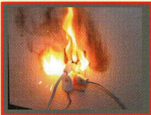
プラグ・コンセントの火災【トラッキング火災再現実験写真】
